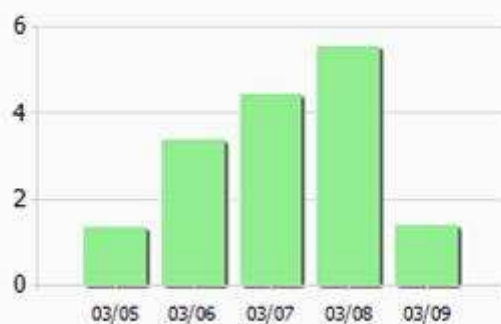
Charge sortante du système de traitement les jours de mesure : Azote global (N.G.L) en kg/j
